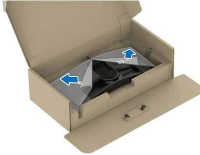
6. スタンドライザーのタブをディスプレイのバックカバーにあるスロットにゆっくりと挿入し、スタンドをゆっくりと正しい位置に下します。
