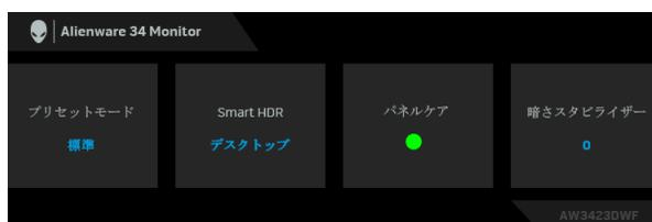
通常、パネルケアは緑のドットを表示します。黄色のドットが表示されている場合は、**ピクセルを最新の状態に更新**を実行することをお勧めします。赤色のドットが表示されている場合は、**ピクセルを最新の状態に更新**を実行せずに 20 時間、または**パネルを最新の状態に更新**を実行せずに 1500 時間使用されたことを示します。詳細については、[OLED パネルのメンテナンス](#)を参照してください。
