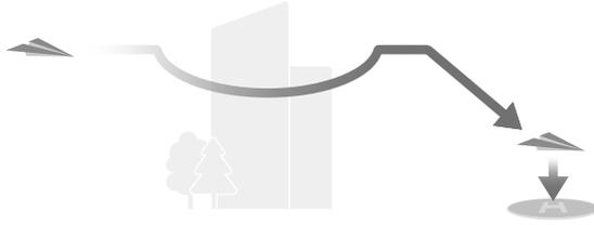
2. 事前設定：RTH開始時に機体がホームポイントから50 mより離れていた場合、機体はRTH経路を計画し障害物を回避しながら開けた場所まで飛行し、RTH高度まで上昇してから最適な経路を通して帰還（Return-to-Home）します。
